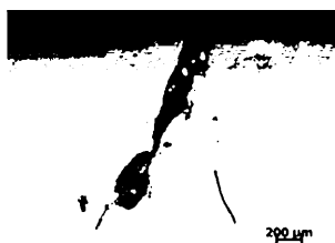
б — конфигурация полости на полированном поперечном микрошлифе, 50 х
