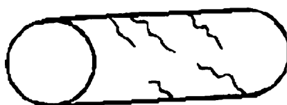
б — дефект на сортовом прокате
