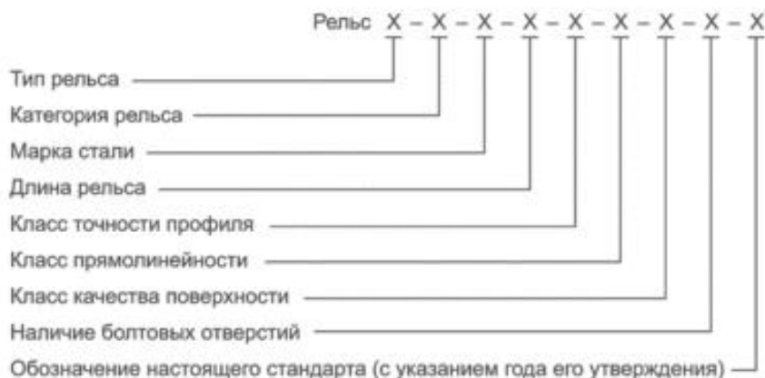
Рисунок В.1 — Схема условного обозначения рельсов при заказе
